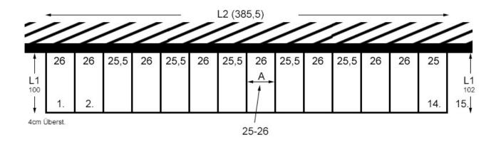
Wir fangen zuerst mit Abmessungen der einzelnen Stufen (A) an. In unserem Beispiel sind alle Stufen zwischen. 25-26 cm.
